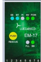
Ascensor en planta con puertas cerradas finalizando la marcha
