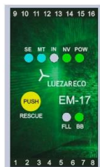
Ascensor en planta con puertas cerradas iniciando la marcha
