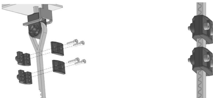
Lasciemo la cinghia appesa sull'installazione e la impegneremo sulla puleggia dentata del limitatore tenendo conto della posizione desiderata del tenditore superiore e inferiore e della direzione di rotazione del limitatore. Il posizionamento davanti o dietro alla cinghia inverte la direzione di rotazione e, di conseguenza, l'azionamento del limitatore di velocità.
