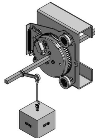
*Nota: se necessario, mettere un arresto per evitare che il paracadute si blocchi quando si appende il peso.*
