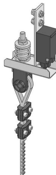
Azionando manualmente i contatti di sicurezza elettrici del tenditore superiore e inferiore, verificheremo che non sia possibile il movimento dell'ascensore.
