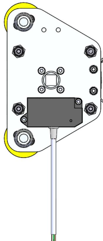
I terminali del dispositivo vengono forniti in formato a puntale. Le estremità del cablaggio sono contrassegnate dal codice di colore dell'immagine in alto a destra.
