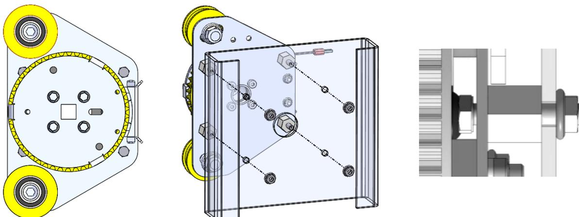
È molto importante che il limitatore di velocità risulti saldamente fissato e livellato; ciò eviterà possibili uscite della cinghia dentata durante il normale funzionamento.
